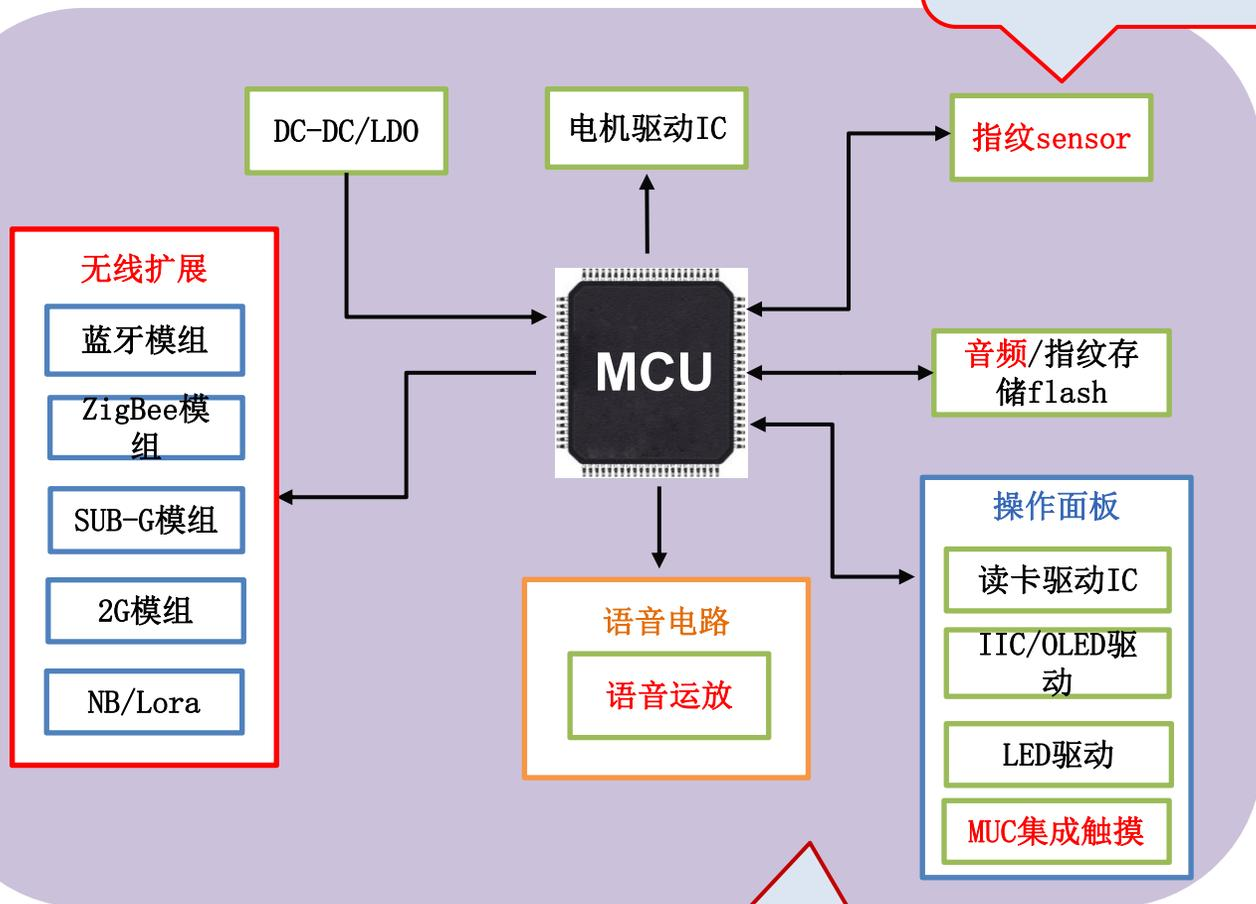
MCU集成触摸按键功能，DAC驱动运放发音，无需采购语音芯片，触摸按键芯片
